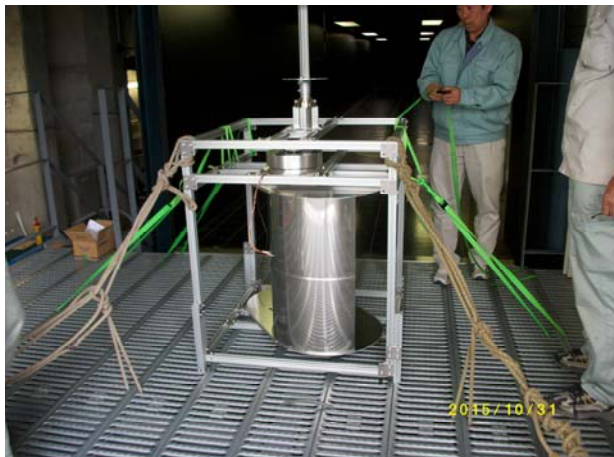
3 風洞実験台取付ロープ固定2
