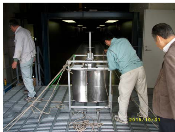
写真 2 風洞実験台取付ロープ固定 1
