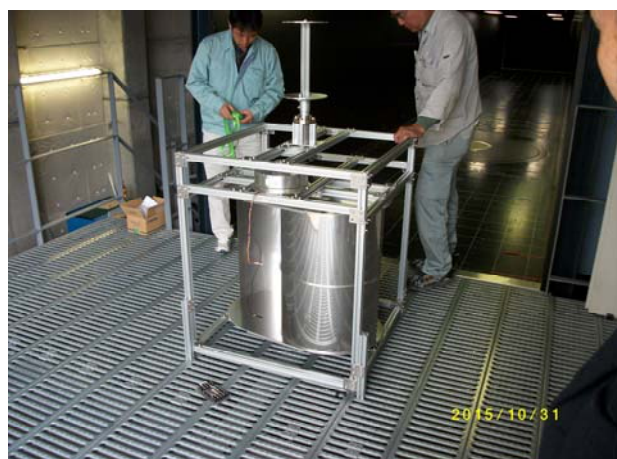
写真 1 風洞実験台設置組立
